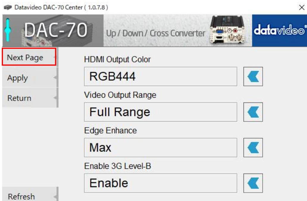
HDMI 出力色、HDMI 出力範囲、およびエッジエンハンスを設定します。ビデオ解像度が 1080p50 / 59.94 / 60 の場合、3G レベル B を有効にします。
