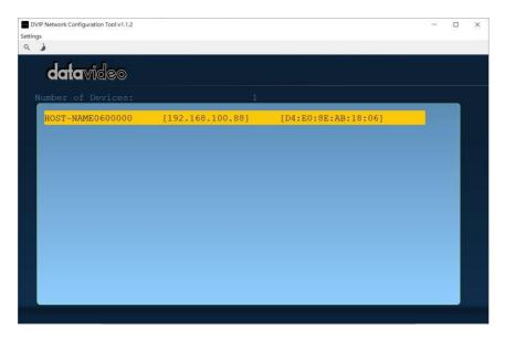
Step 3: [HOST NAME]を押して、ネットワーク設定のポップアップウィンドウを表示します。
