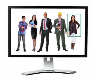
5. ターゲットを見失った場合、PTC-285は見失った位置で数秒間停止し、その後最初の位置へ戻ります。トラッキングターゲットが再び現れると、PTC-285は自動的にターゲットを追尾します。
