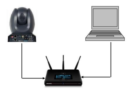
カメラのDHCPモードを有効にするには、ルーターによってPTC-285に動的IPアドレスを割り当てる[IP Configuration Type]ドロップダウンメニューから [Dynamic IP Address]を選択してください。[Apply]ボタンをクリックして設定を保存し、PTC-285を再起動してください。
