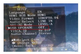
9. PTC-285リモコンの[Micro Joystick]を左側または右側に動かして、[USB Upgrade]オプションを[On]に設定してください。確認のため、PTC-285リモコンの[Micro Joystick]を押してください。PTC-285は自動的にファームウェアのアップデート手順を開始します。ファームウェアのアップデート手順の過程で、[Updating! Please Wait!]と表示されます。ファームウェアの更新手順が終了すると、PTC-285は自動的に再起動し、ファームウェアの更新は正常に行われます。
