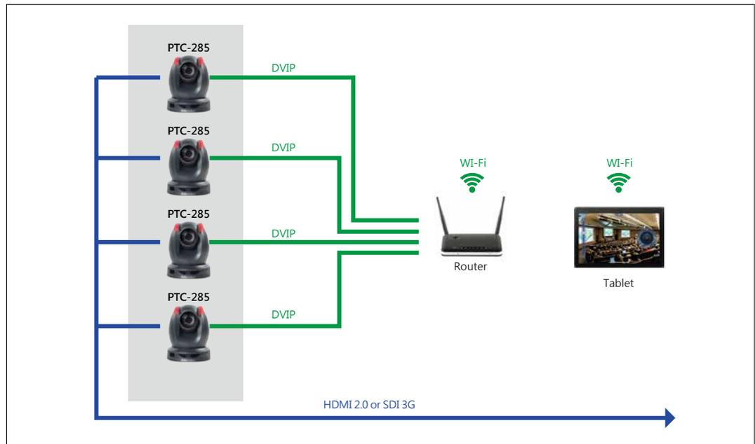
カメラコントロールアプリは、datavideo 社の PTZ カメラをコントロールすることができます。タブレットにアプリをインストールすれば、同じネットワーク内のカメラを簡単にコントロールできます。
