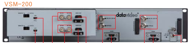
VSM-200 USBコネクタ HDMI出力コネクタ HDMI入力コネクタ HDMI入力コネクタ HD/SD-SDI入出力コネクタ HD/SD-SDI入出力コネクタ HD/SD-SDI入出力コネクタ DC電源入力12V 19W
